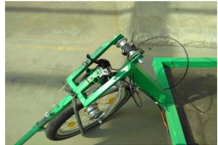
Angekuppelt wird der Anhänger einfach an der speziellen Kupplung, die an der Sattelstütze angebracht ist. Dazu musst Du die große Mutter von Hand runter drehen, die Öse des Anhängers einhängen und danach die Mutter wieder drauf schrauben. Die Mutter bitte nur von Hand gut festdrehen (bitte kein Werkzeug benutzen).
