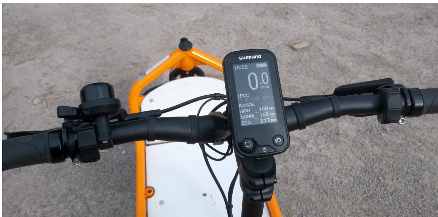
Abbildung 2: Display und Lenkstange mit Schalter am linken (Unterstützungsstufe) und rechten Lenkergriff (Gang)
