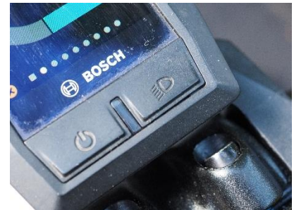
Anzeige mit Schalter zum Einschalten und für das Licht
