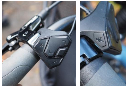
Hier kann die Unterstützung erhöht oder gedrosselt werden. Oben ist der Knopf für die Schiebehilfe
