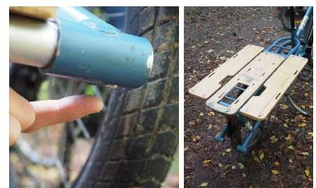
Die Trittbretter sind mit Metallnippeln von unten gesichert
