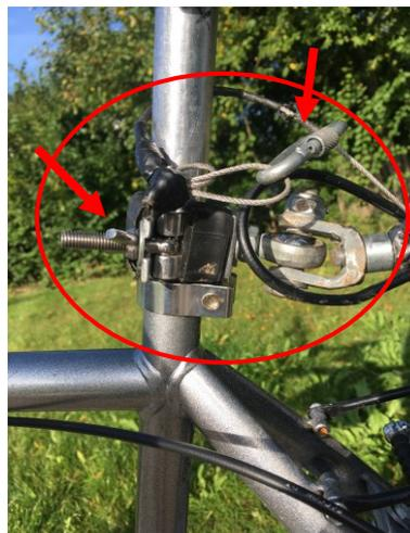
Kupplung möglichst tief, Abreißsicherung eingehängt, Flügelmutter fest angezogen.
