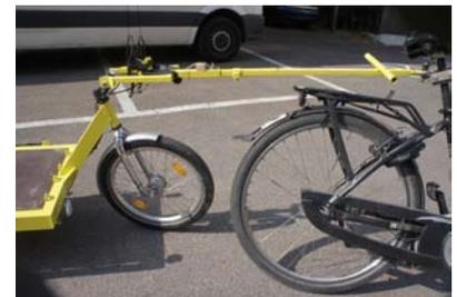
Der Anhänger ist mit einer Auflaufbremse ausgestattet. Diese bremst von alleine mit, wenn Du mit dem ziehenden Fahrrad bremst.
